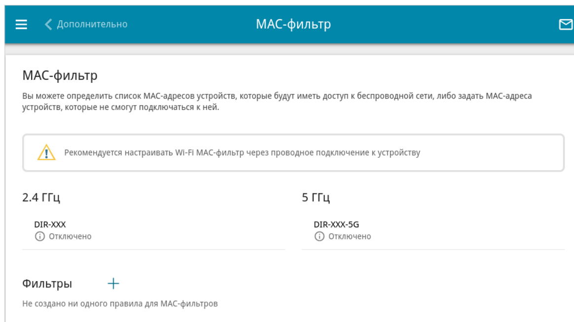
Рисунок 140. Страница для настройки MAC-фильтра для беспроводной сети.
