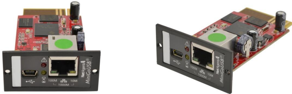
Внешний вид карты SNMP с дополнительным портом
